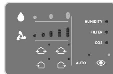
Det er muligt at ændre indstillingen for fugtighedsstyring ved at trykke på "H" -knappen for at tilpasse værdien til det område, hvor den er installeret. Når fugtigheden overstiger den indstillede værdi, suger produktet kontinuerligt luft ved den maksimale hastighed, indtil fugtighedsniveauet vender tilbage under den indstillede værdi. I tilfælde af flere enheder kører alle produkterne automatisk udsugning.
