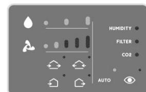
Det er muligt at ændre indstillingen af fugtighedsstyringen ved at trykke på "H" -knappen for at tilpasse værdien. Når den indstillede fugtighedsværdi overskrides, suger produktet luft ud ved maksimal hastighed, indtil fugtighedsniveauet er under den indstillede værdi. I tilfælde af flere enheder kører alle produkterne automatisk udsugning, indtil den indstillede værdi nås.
